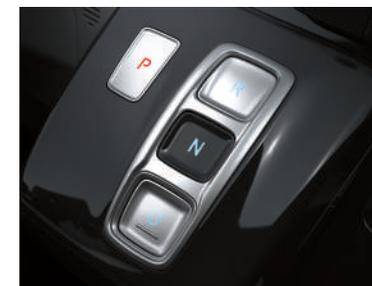
АКПП с электронным управлением переключением передач (Shift-by-Wire)
