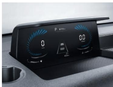
Панель приборов с экраном диагональю 4,2 дюйма (в стандартной комплектации)
