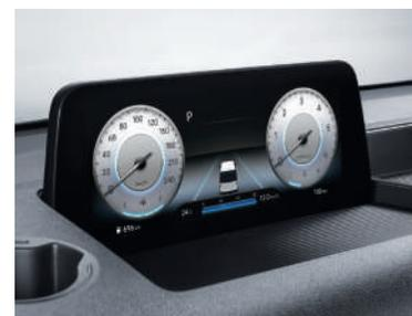
Панель приборов с экраном диагональю 10,25 дюйма (опционально)
